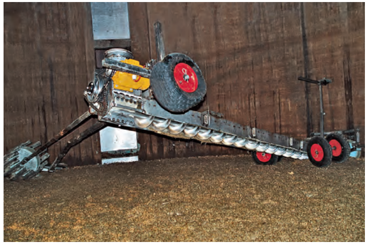
Die Schneckenfräse ist geeignet für reine Maissilage oder CCM. Sie weist einen geringen Verschleiss auf und ist zu 100% aus Chromstahl gefertigt.
